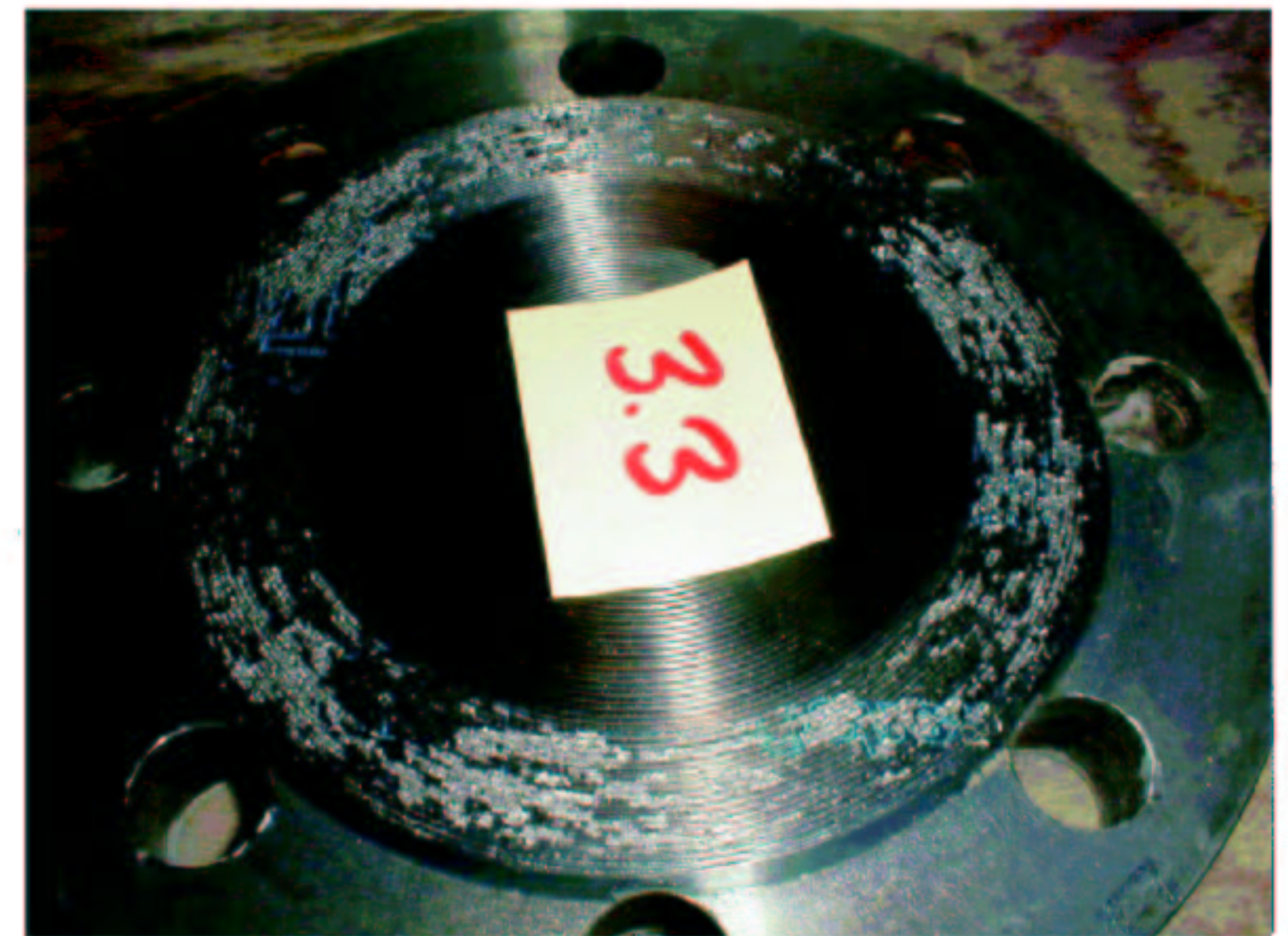
Bild 22 Anhaftungen am Flansch nach gelöster Dichtung
