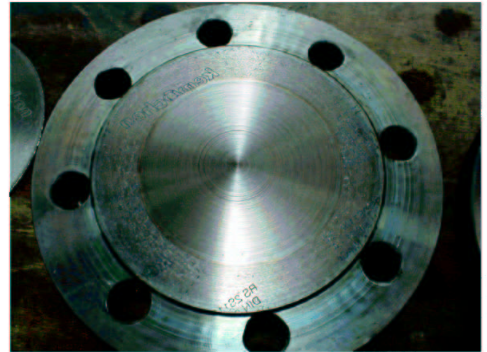
Bild 26 Geringe Anhaftungen nach dem Ablösen der Dichtung
