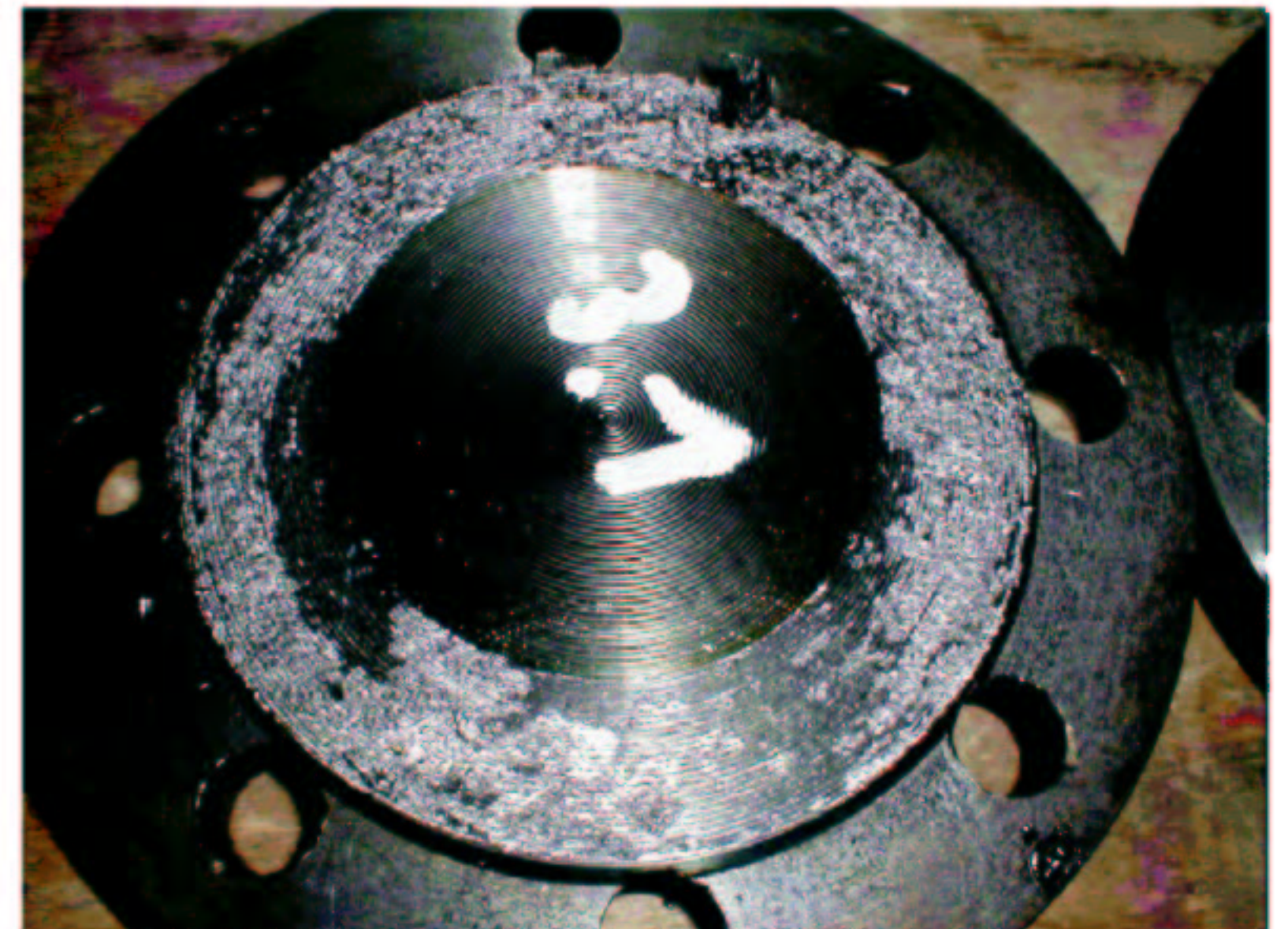
Bild 7 Starke Anhaftung des Graphit's auf der Dichtleiste
