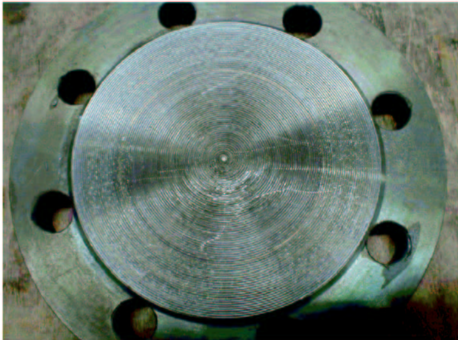
Bild 29 Keine Anhaftungen am Gegenflansch
