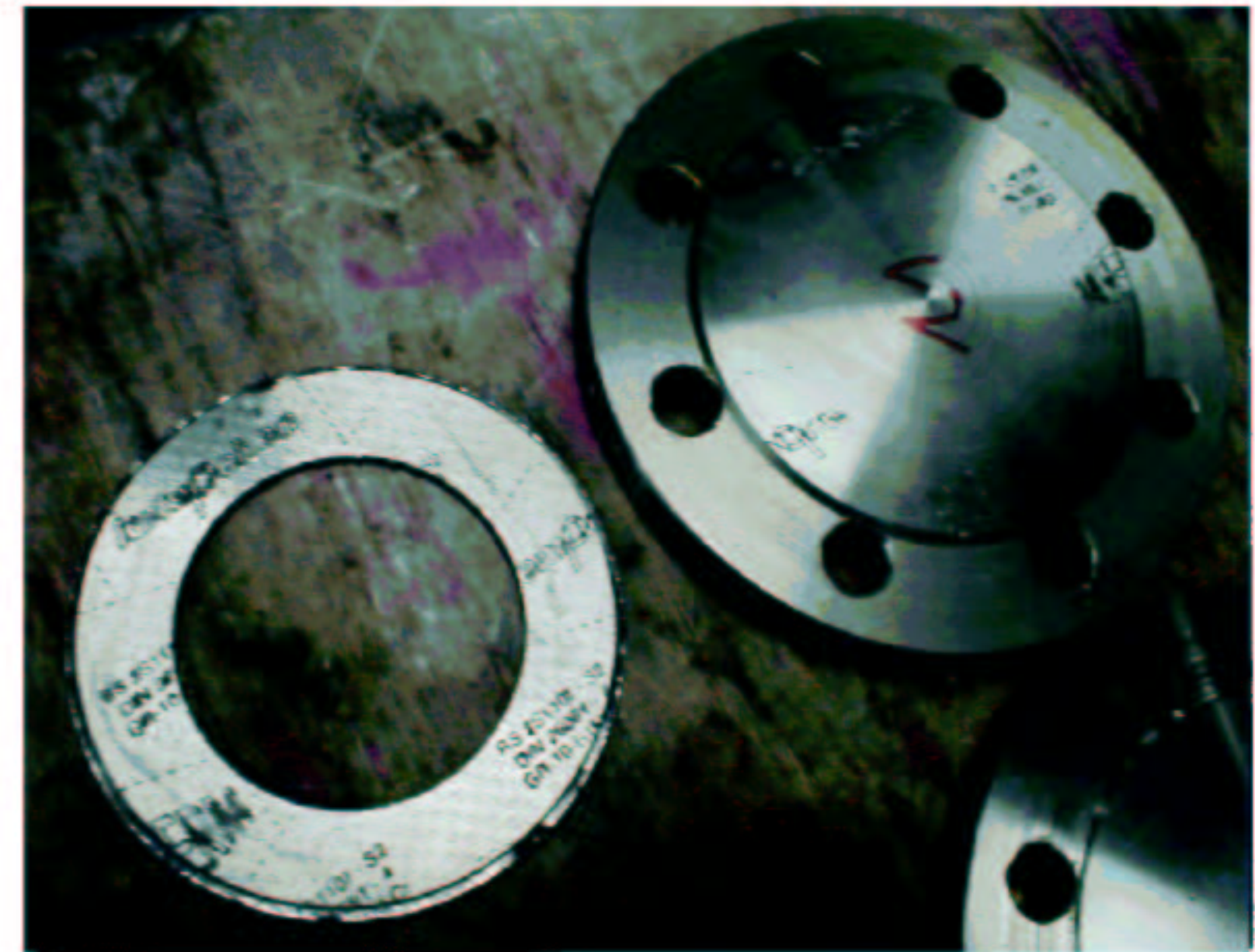
Bild 3 Dichtung abgelöst, geringfügige Anhaftungen vorhanden
