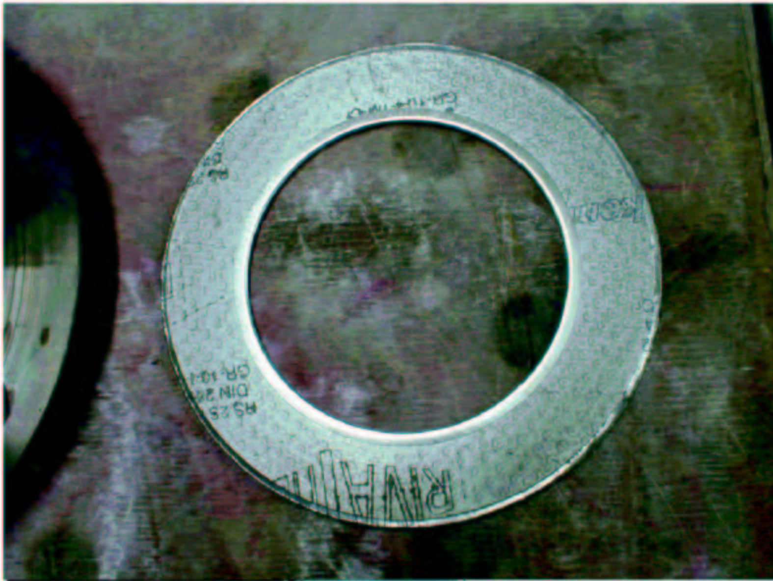
Bild 20 Abgelöste Dichtung (vergl. mit Bild 17)
