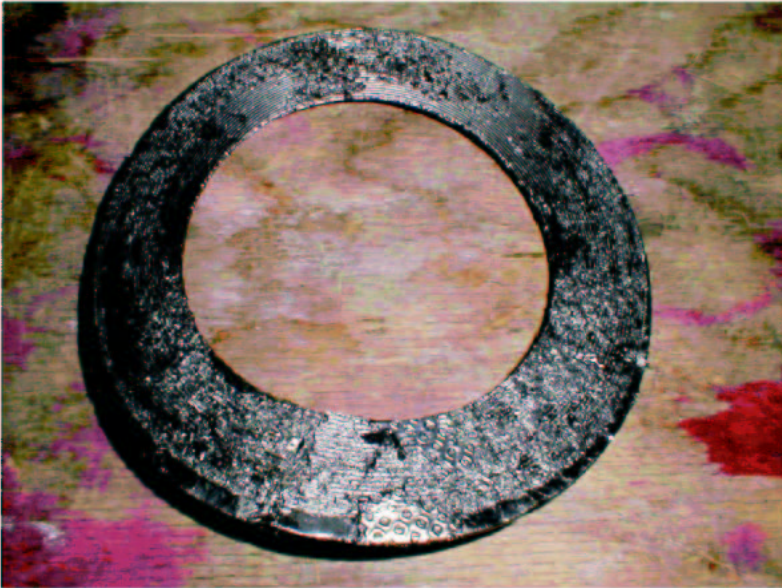
Bild 8 Zerstörte Kempchendichtung auf Grund starker Anhaftung
