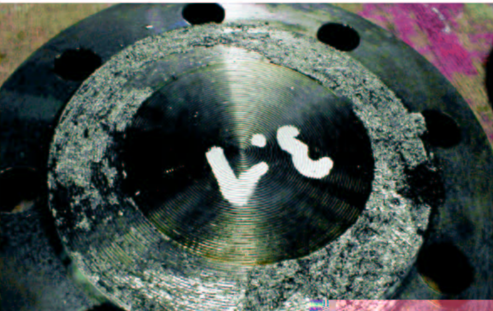
Bild 8 Zerstörte Kempchendichtung auf Grund starker Anhaftung
