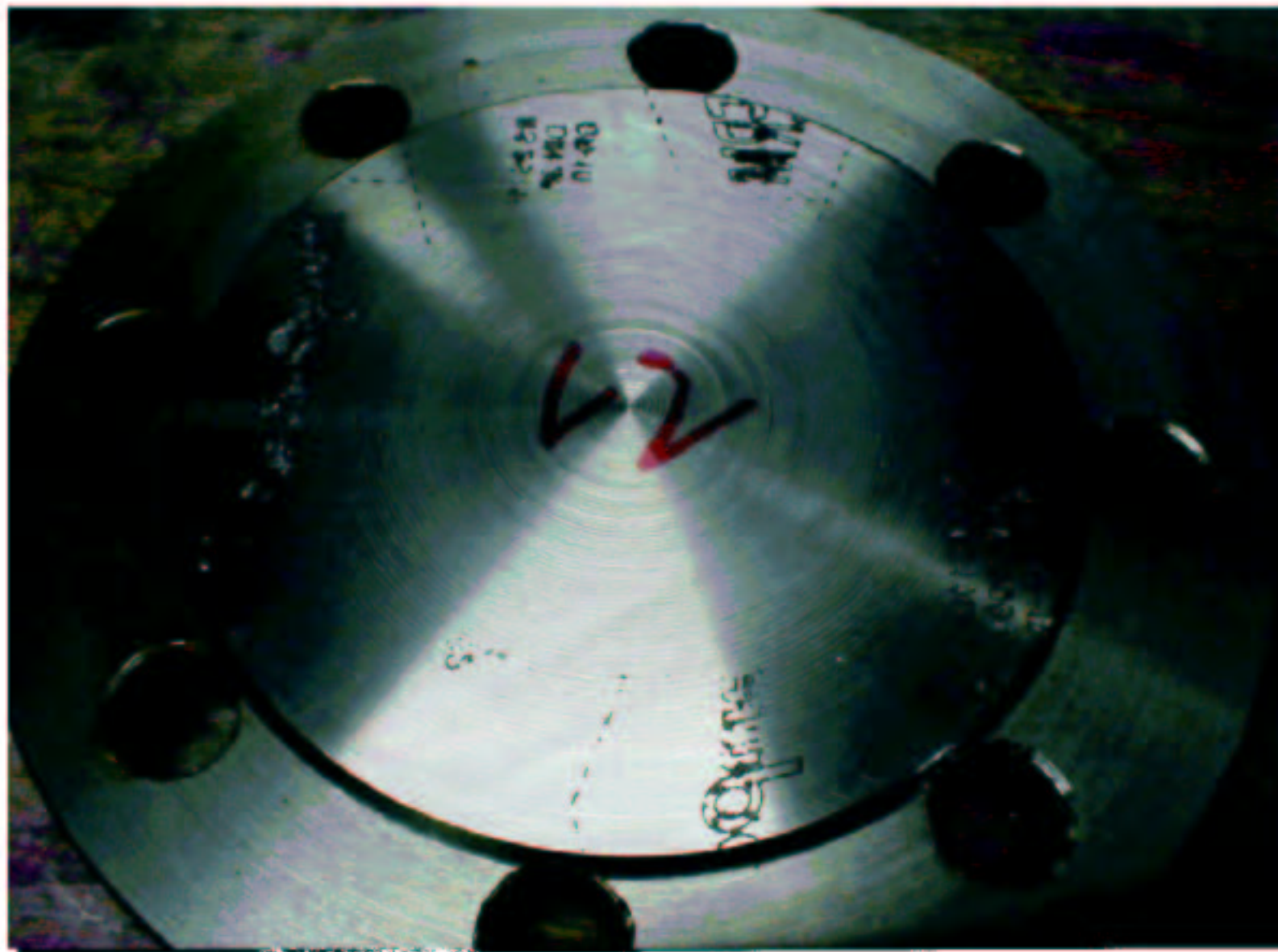
Bild 4 Detailaufnahme; Dichtung abgelöst, geringfügige Anhaftungen vorhanden
