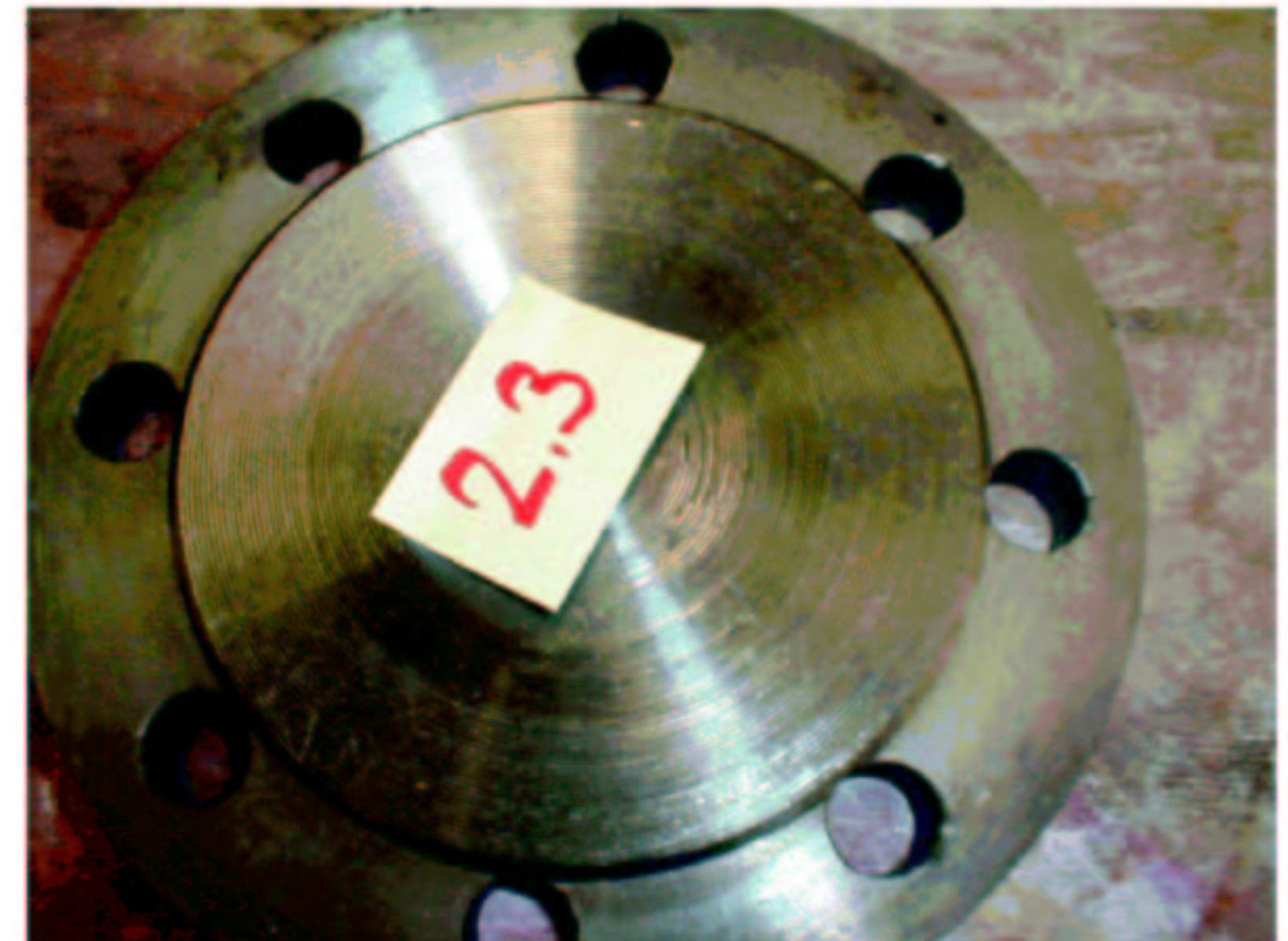
Bild 14 Keine Anhaftungen am Gegenflansch
