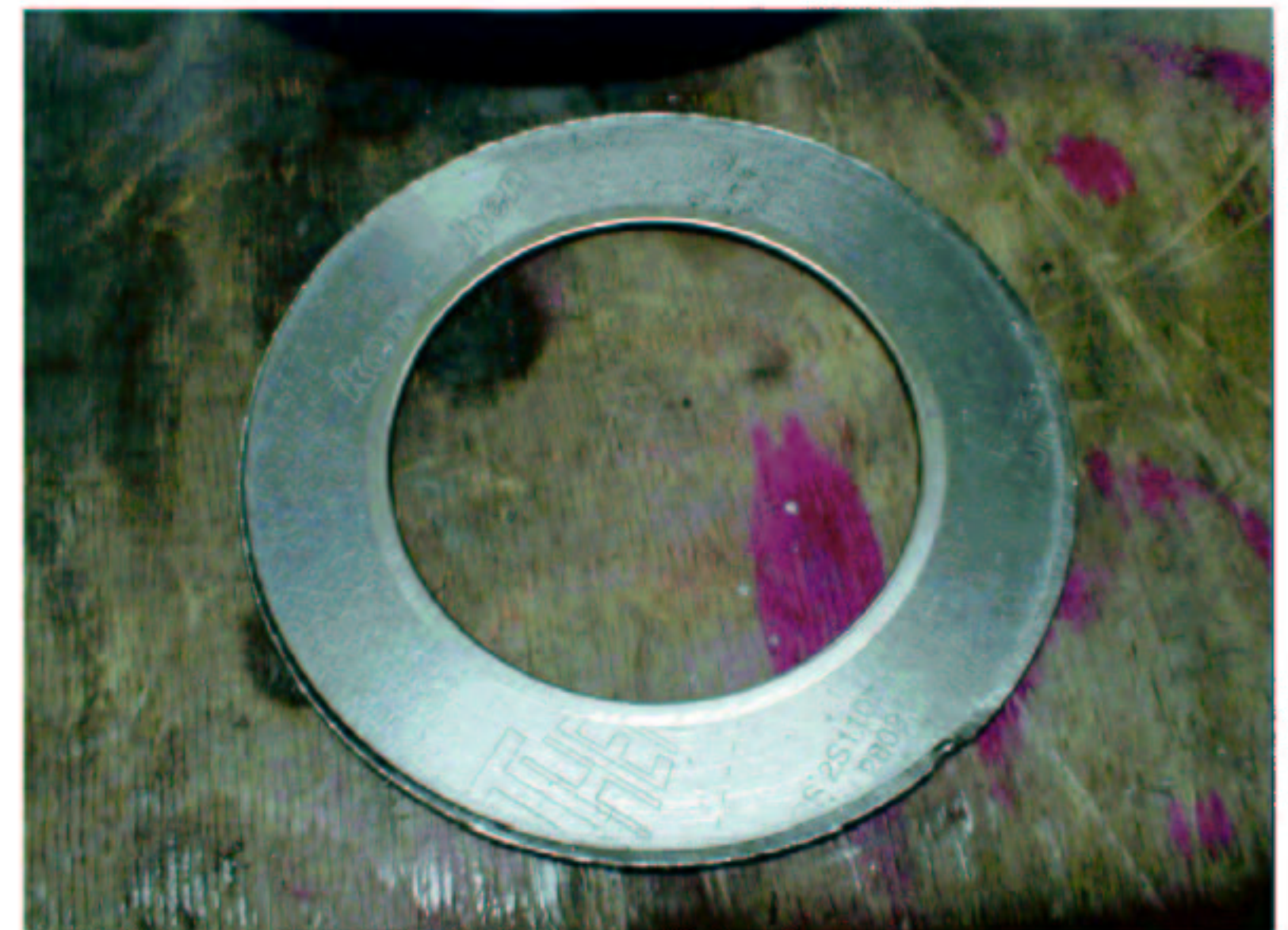
Bild 27 Abgelöste Dichtung (vergl. mit Bild 25)
