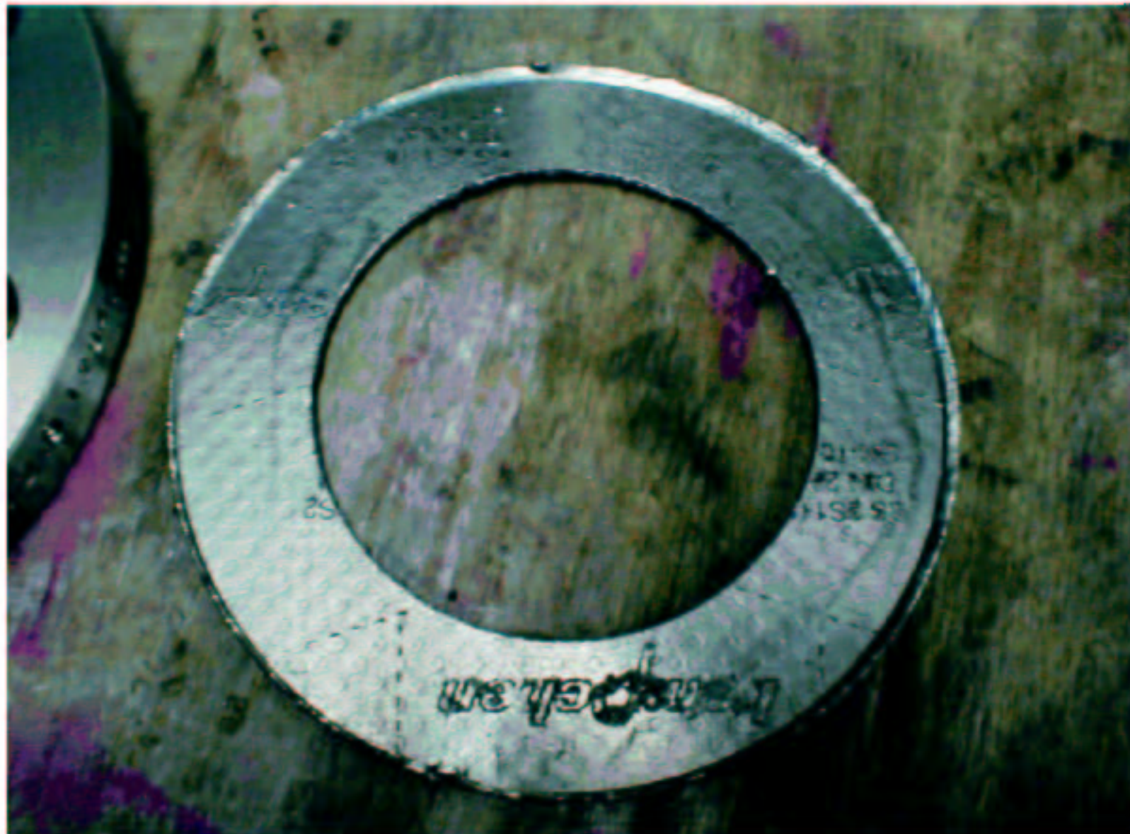
Bild 5 Detailaufnahme; Dichtung mit leichten Ablösungen, vom Schriftzug ausgehend
