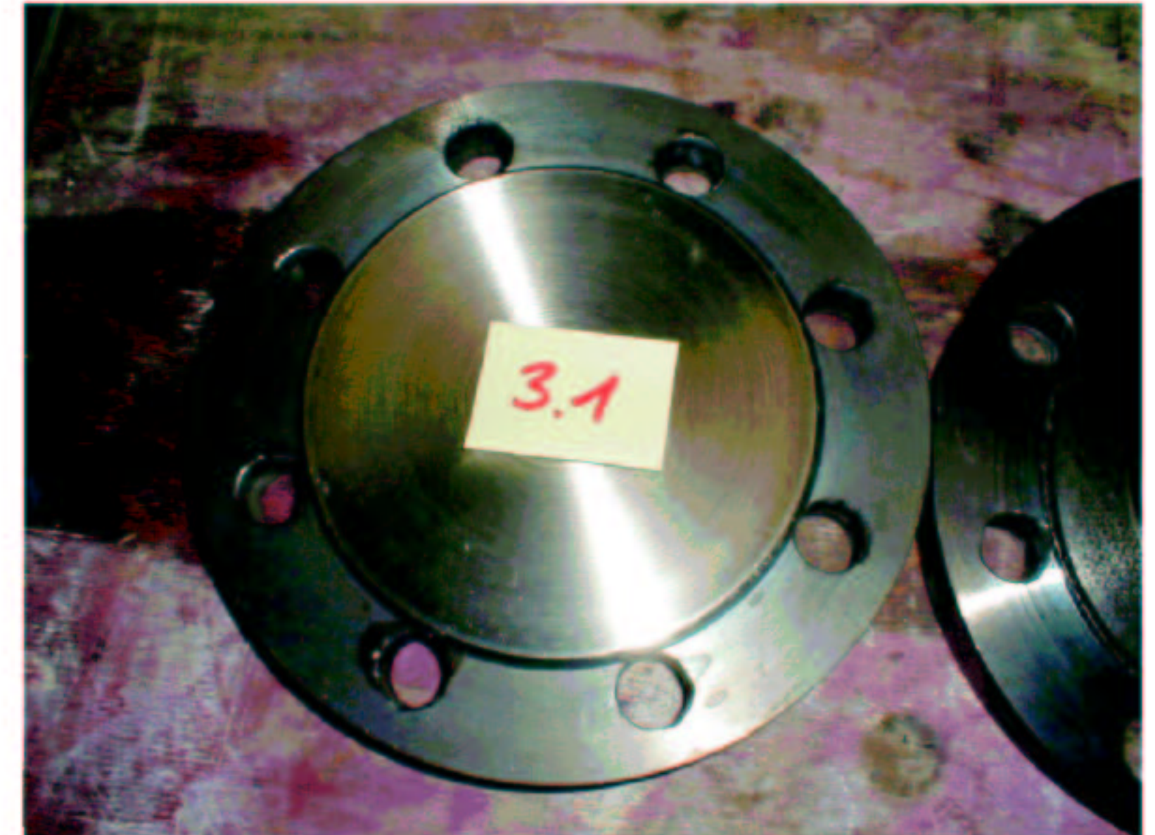
Bild 18 Detailaufnahme, Gegenflansch ohne Graphitanhaftungen
